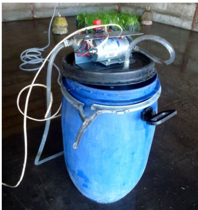
Figura 2. Reservorio plástico desde el cual la bomba alimenta el equipo de simulación.
